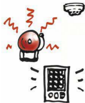
自動火災報知設備
