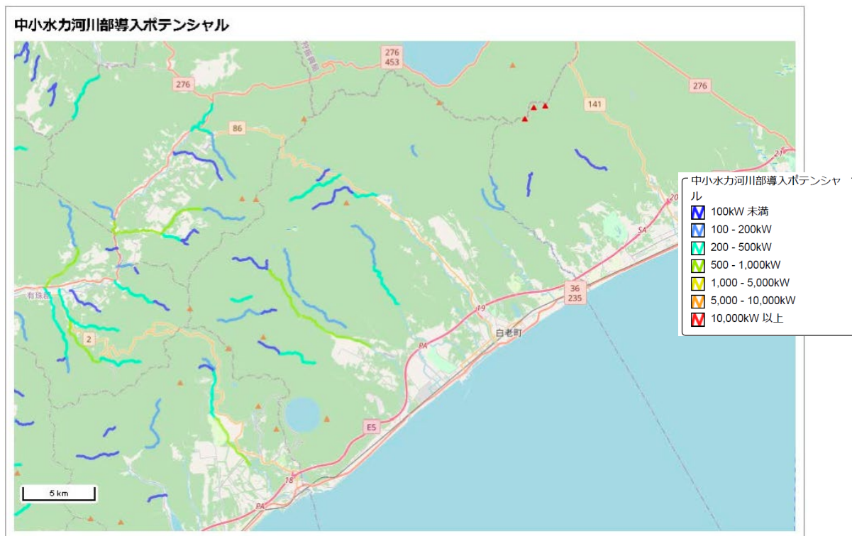
図 30 白老町の中小水力発電（河川部）の導入ポテンシャルマップ
